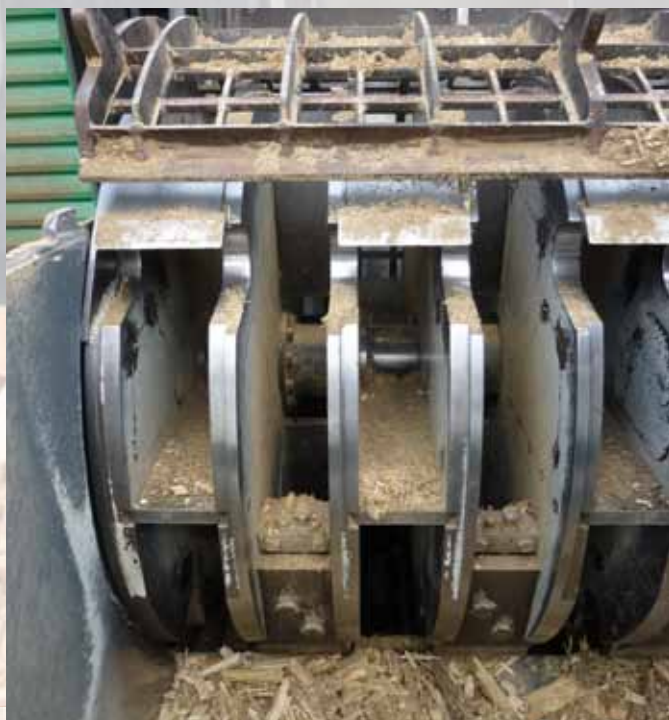
Das neuartige Rotorkonzept erlaubt das problemlose Wechseln aller Verschleißteile im eingebauten Zustand. Messer, Messerhalter, Klemmplatte, Stellbacken und Zwischenplatten sind verschraubt und wechselbar. Auch die Rotorscheibe und der komplette Rotor - Standard oder Bio - ist tauschbar.
