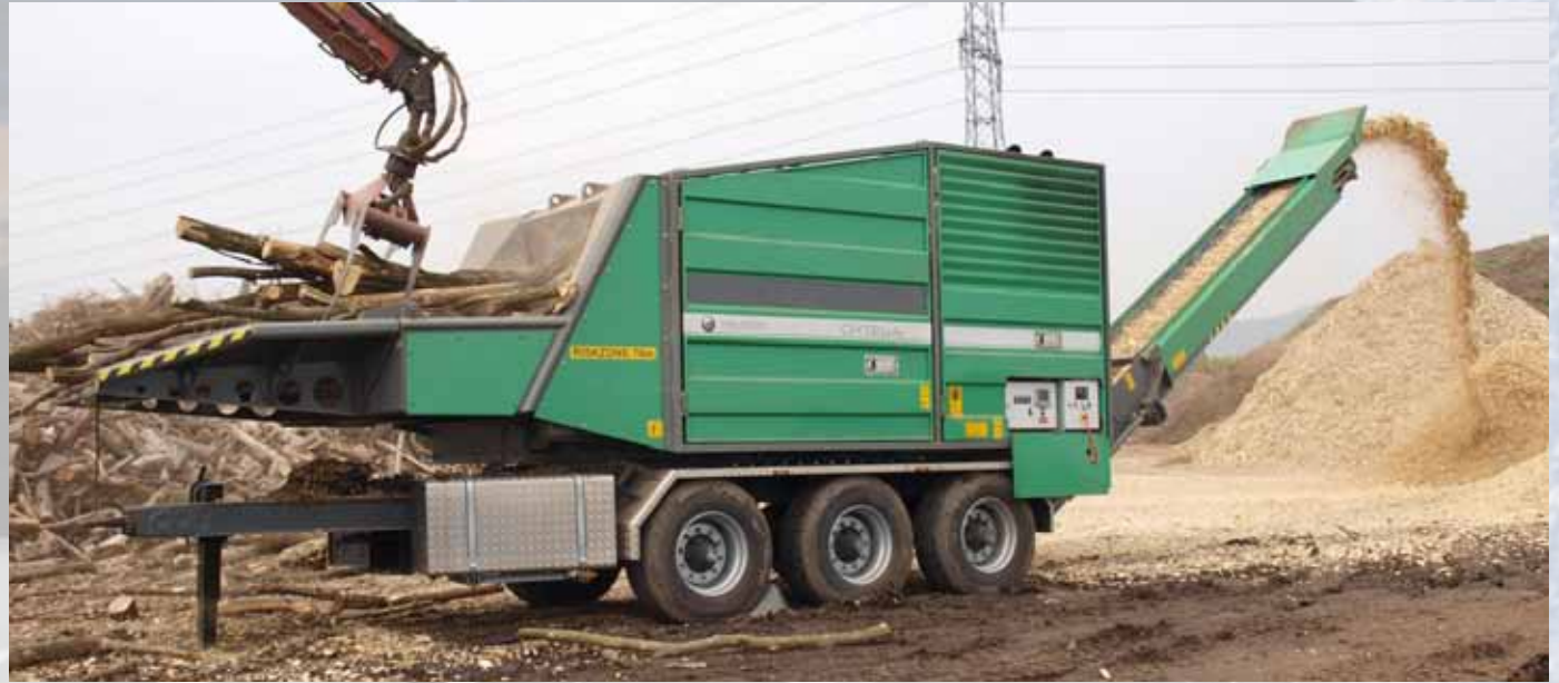
Standardmäßig ausgestattet ist der Hacker mit Mercedes Benz Motor OM 502 LA / 8 Zylinder V, Leistung: 480 kW (653 PS) bei 1800 u/min, Abgasstufe: Euromot 3A. Eine Besonderheit der Neuson-Mobilhacker ist die automatische Störstofferkennung, d. h. bei einem Fremdkörpereinzug wird der Antrieb automatisch entkoppelt.
