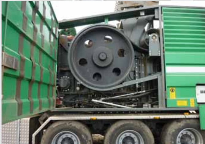
Neuson ECOTEC Hacker CH1266 - stabile Einzugsdrehzahl dank großer massiver Schwungmasse.
