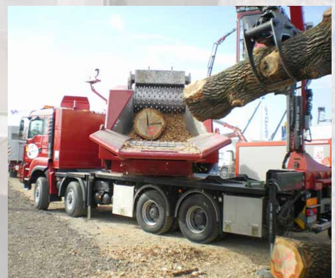
Derzeit ist ein Aufbau der Maschine auf LKW mit Drehkranzgestell sowie einen Aufbau auf 3-Achsanhänger möglich. Die Variante auf LKW ermöglicht natürlich einen optimalen Wirkungsradius.
