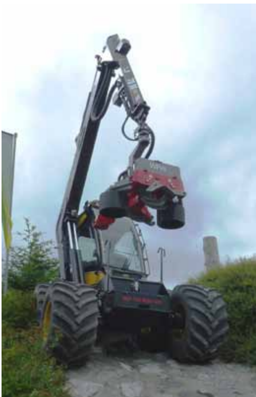
Bis zu 80 % Steigung klettert die neue D-Serie rauf wie runter, dank verbesserter IQAN Abstimmung bei 550 - 580D (Mountain Taste) sowie stärkerer Radmotoren beim 590D
