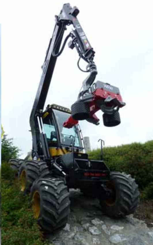
Bis zu 80 % Steigung klettert die neue D-Serie rauf wie runter, dank verbesserter IQAN Abstimmung bei 550 - 580D (Mountain Taste) sowie stärkerer Radmotoren beim 590D
