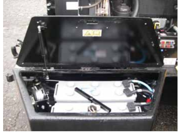
Im rechten Seitenkasten findet sich Platz für Batterie, Bodenwannenkurbel und elektrischen Haubenöffner. Der linke Seitenkasten ist leer und bietet viel Stauraum.
