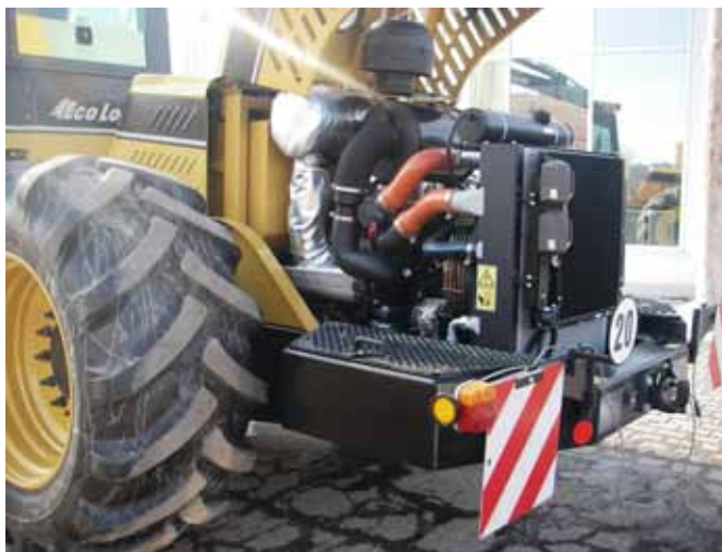
Optimierte Luftführung/Hauben/Kühler Die Luftführung der Hauben wurde optimiert und erreicht nun die optimale Kühlleistung: 7% breiter, 29% höher = 39% mehr Oberfläche führen beim Kühler zu einer theoretischen Erhöhung der Kühlleistung von 56%!
