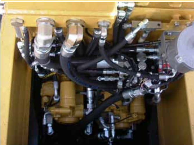
Foto links: Viel Platz und gut zugänglich. Tandempumpenantrieb mit 2-fachem Antrieb. Die Übersetzung beträgt 1.28 (EcoLog 590D = 1.00). Der Pumpenregler der Kranpumpe wurde erneuert um eine weichere Auslenkung zu ermöglichen.
