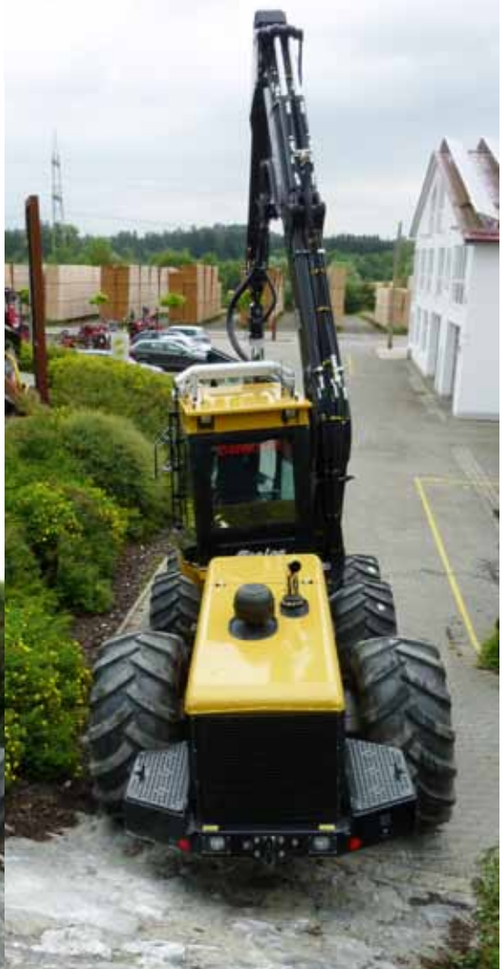
Bis zu 80 % Steigung klettert die neue D-Serie rauf wie runter, dank verbesserter IQAN Abstimmung bei 550 - 580D (Mountain Taste) sowie stärkerer Radmotoren beim 590D
