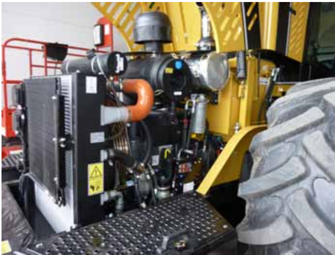
Die EcoLog Harvester 550D - 590D sind mit den Motoren MB OM 926 LA ausgestattet
