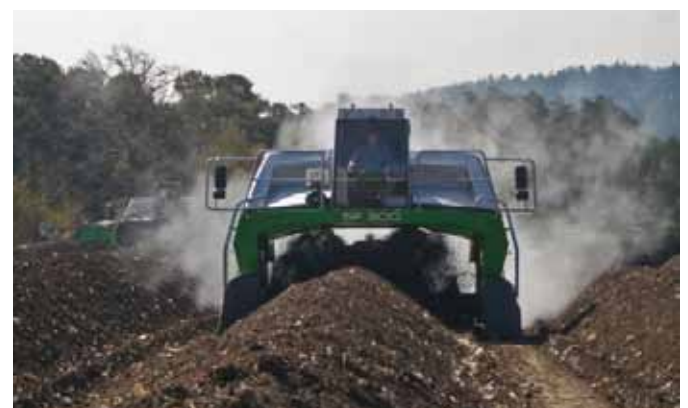
Neuson ECOTEC Wendemaschinen garantieren die Konstanz einer definierten Qualität bei der biologischen Verwertung. Das gibt Sicherheit und macht die Aufgaben wirtschaftlich und kalkulierbar.
