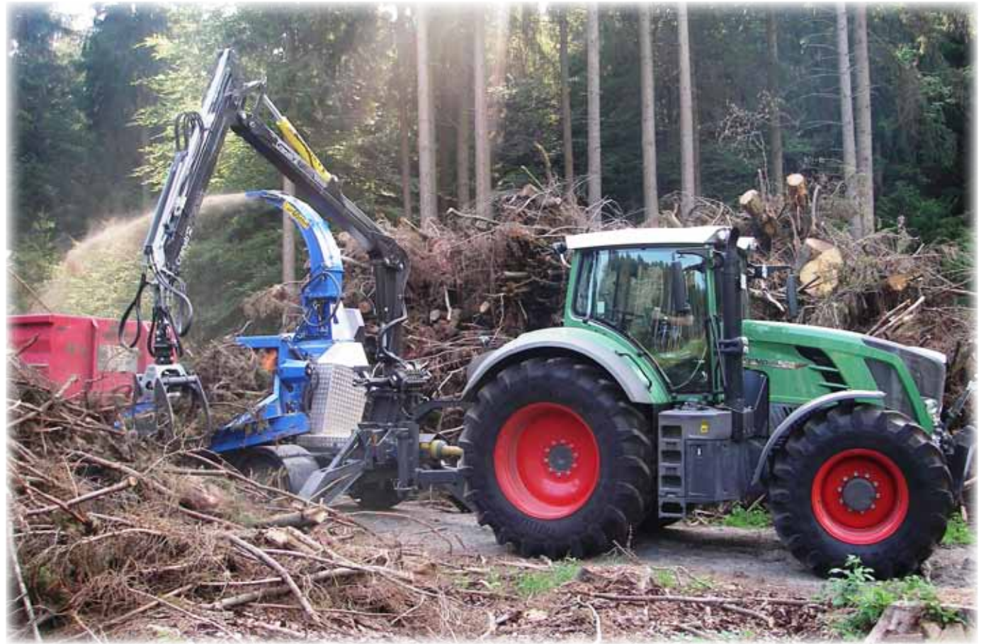
Bruks 605PT Trailer im Einsatz mit Zapfwellenantrieb ab 200 - 400 PS
