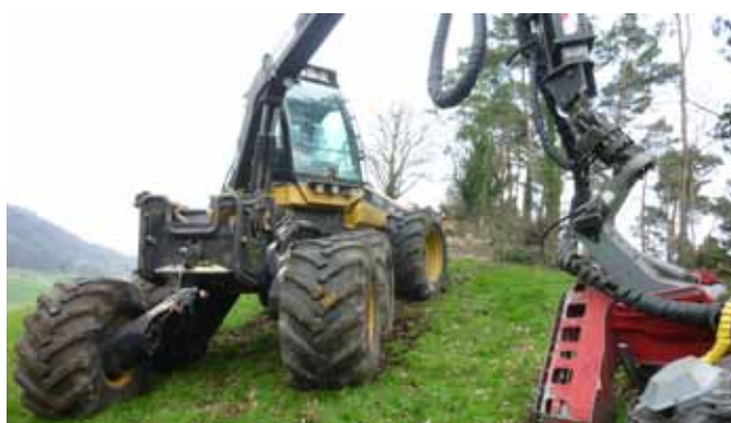
VOLKtrans GmbH, CH- Benken, EcoLog 590D, 570D; „Früher Timberjack, heute EcoLog! Das Pendelarmsystem ist einmalig und bietet viele Vorzüge.“
