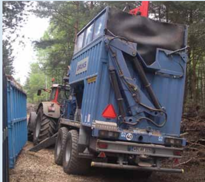
Dank der hydraulischen Federung an den BPW Achsen steht der Hacker in schwierigem Gelände sicher
