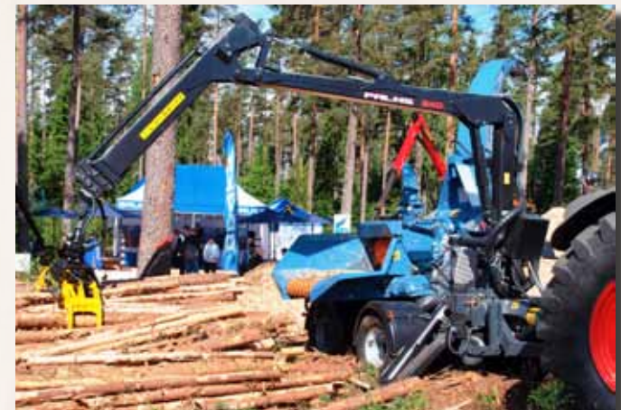
Bruks 605 PT Trailer auf Tandemhänger mit Zapfwelleantrieb und starkem PALMS Kran
