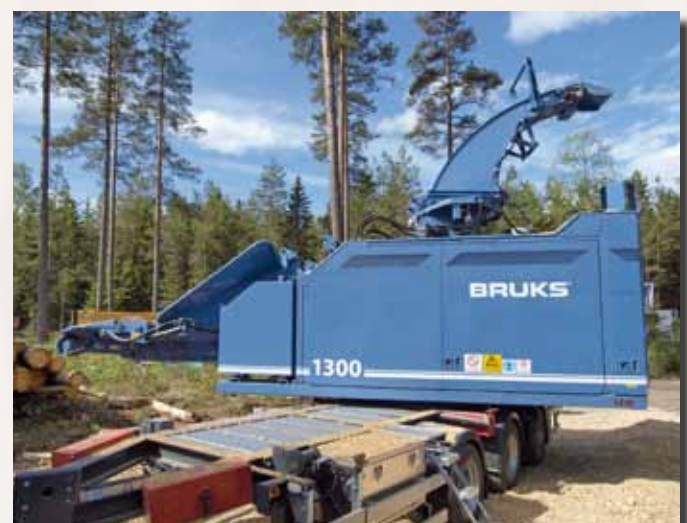
Bruks 1300RT Trailer auf 3-Achser Sattelaufleger mit Kran vom LKW bedienbar, 240° Schwenkbar mit Auswurfrohr separat 300° drehbar
