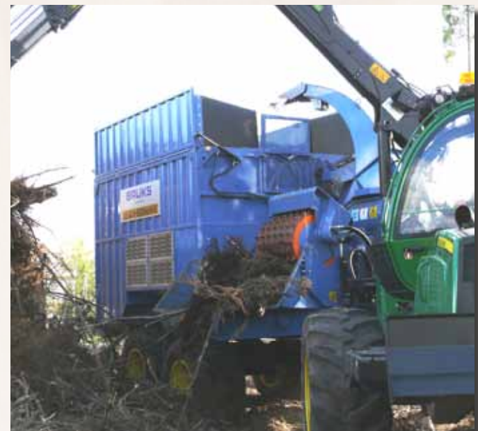
BRUKS 805.2 aufgebaut auf Forwarder mit hochklippbarem 21 m³ Container
