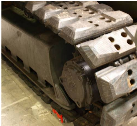
Fotos: Gummierte Stahlplatten für schwierige Einsatzgebiete
